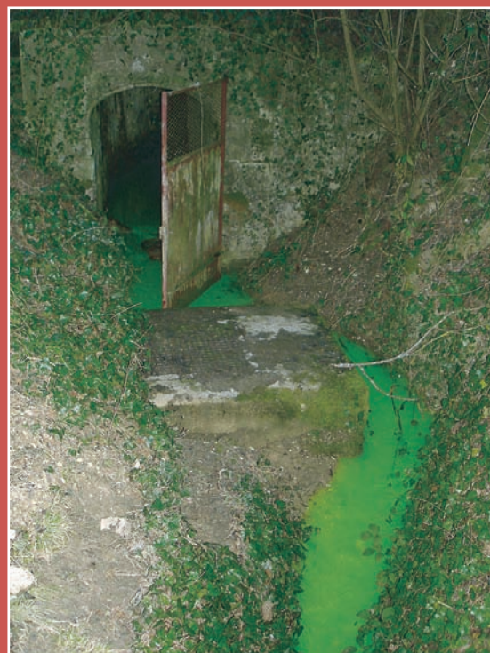
Restitution des traceurs aux sources d'Isse (photo ci-contre) et de Trépail (ci-dessus), Montagne de Reims, Marne. Release of dye tracers in the springs of Isse and Trépail (Mountain of Reims, Champagne).
